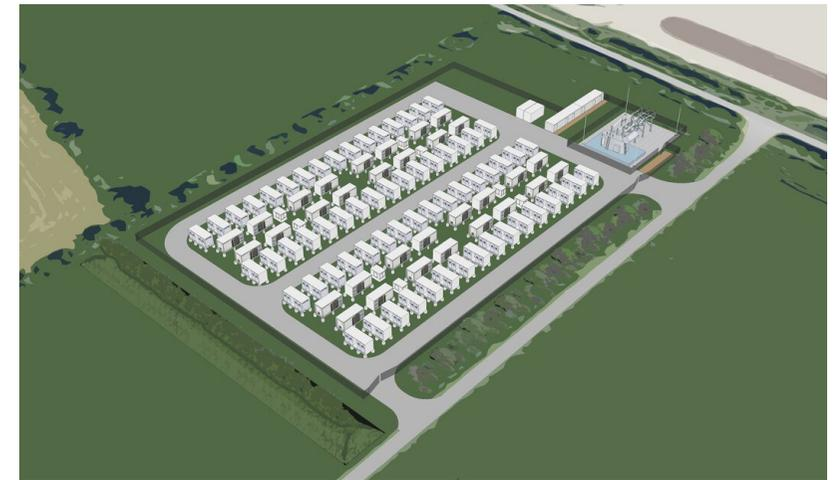
Geplanter Batteriespeicher mit 103,5 MW Leistung und 238 MWh Speicherkapazität
